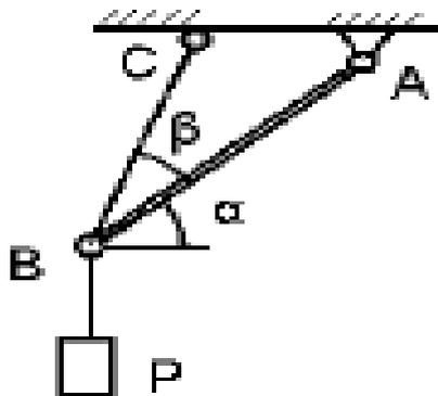
2. Груз весом  $P = 10 \text{ Н}$  подвешен на двух тросах  $AB$  и  $BC$ , составляющих с горизонтальной прямой углы  $\beta = 15^\circ$  и  $\alpha = 30^\circ$ . Определить усилия в тросах.
